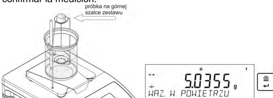
11. En el siguiente paso, colocar la muestra en la parte inferior del platillo (la medición de la muestra en el líquido) y después de la estabilización de la indicación confirmar la medida .
