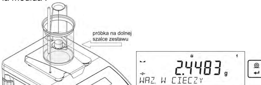
12. Después de la aprobación de la segunda medición, el programa calculará automáticamente la densidad del líquido, que se muestra en la pantalla, y el informe será enviado de la medición al puerto de la impresora seleccionada
