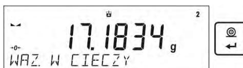
10. Después de la aprobación de la segunda medición, el programa calculará automáticamente la densidad del líquido, que se muestra en la pantalla, y el informe será enviado de la medición al puerto de la impresora seleccionada
