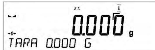
El pictograma del termómetro parpadeante significa que la temperatura dentro de la balanza no es estable, esto puede resultar en una medición de masa inexacta. Para tal caso, se recomienda esperar hasta que la temperatura se estabilice o realizar un ajuste de equilibrio (supresión del pictograma del termómetro parpadeante)
