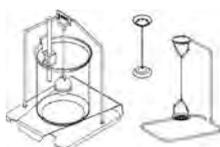
Es aplicable con la balanza con resolución de al menos 1 mg. Diseñado para la determinación de la densidad de sólidos y líquidos. El procedimiento es completamente automático, es decir, el usuario solo coloca muestras en las bandejas de pesaje del kit.
