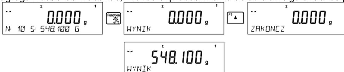
El mensaje <RESULTADO> aparecerá en la línea inferior, indicando que la pantalla principal muestra el resultado de la masa total de todas las muestras pesadas, y el total se imprimirá automáticamente.
